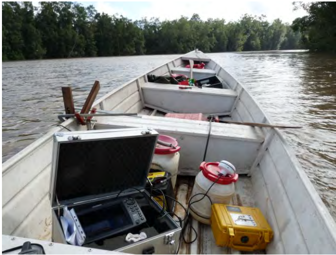
Figure 8. Bateau sur la crique Coswine équipé de la sonde (installée latéralement), GPS et écran du sonar.
